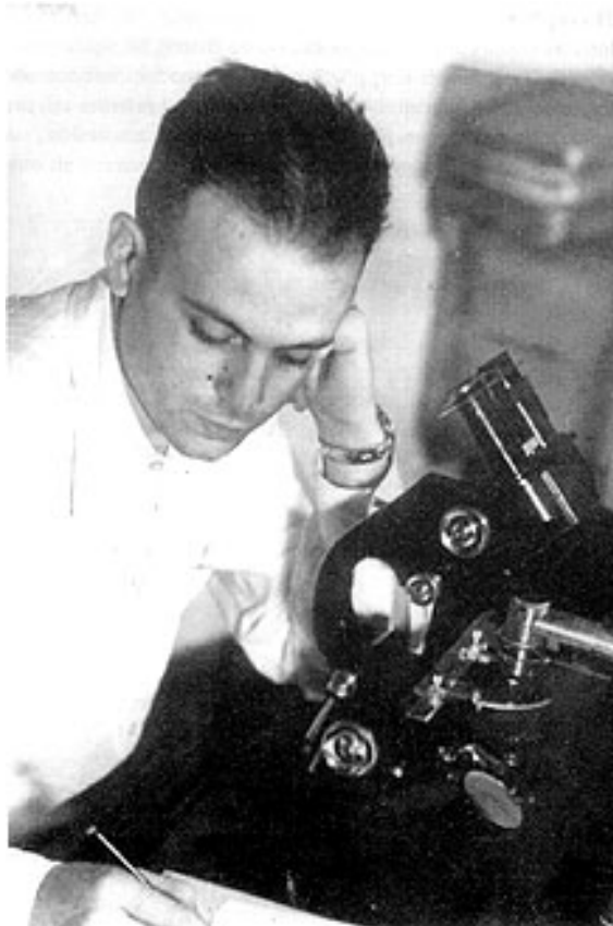
Figura 17 – César Lattes em 1949 na etapa de observação no microscópio óptico, fase em que se pode ‘varrer’ a placa em busca de eventos na superfície e/ou na profundidade da gelatina de AgBr, fazer medidas de comprimento dos traços e de densidade de grãos revelados ao longo das trajetórias. Fonte: Arquivo Central/Siarq-Unicamp.
