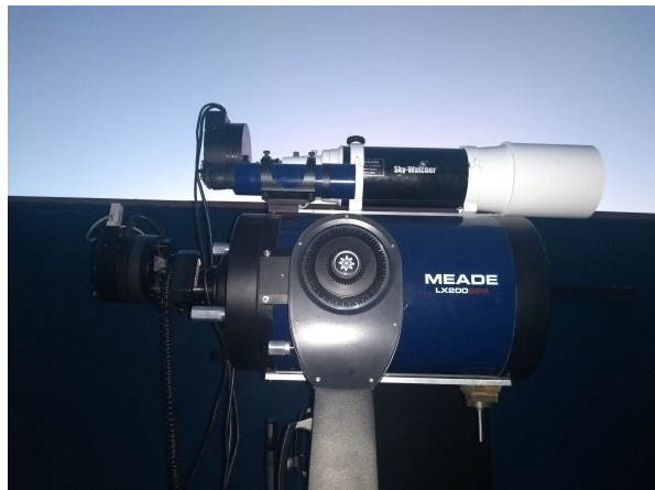
FIGURA 10. Telescópio Meade LX200 GPS com uma luneta de acompanhamento de 200 mm, acoplada a uma CCD de mesma característica: SBIG ST-7 XME-D.
