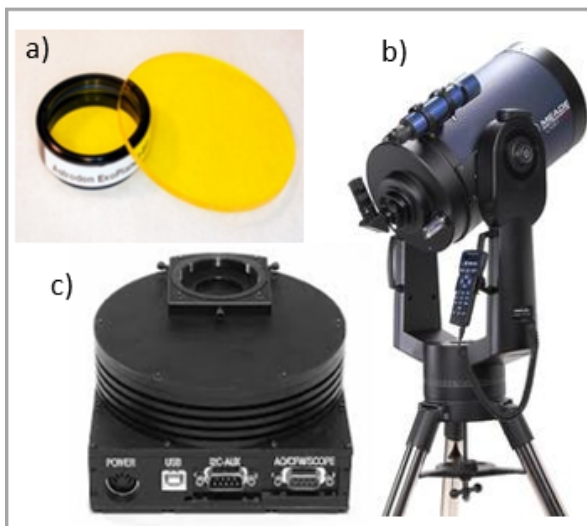
FIGURA 9. Instrumentação usada nas observações da estrela WASP-2 A. a) Filtro Astrodon ExoPlanet-BB; b) Telescópio refletor MEADE 10'' Schmidt-Cassegrain, LX200 GPS; c) Câmera CCD SBIG ST-7 XME-D.
