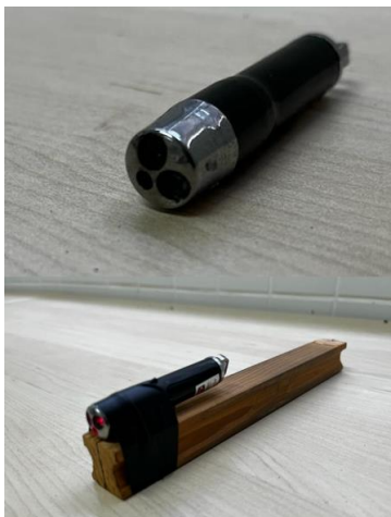
Figura 20 - Laser (imagem superior) e suporte de madeira onde o laser foi fixado (imagem inferior)
