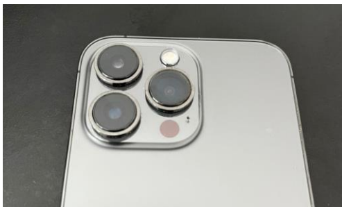
Figura 14 - Câmera do celular utilizada no experimento. Essa área será encaixada na caixa de papel para evitar o excesso de luz externa.
