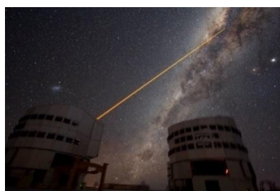
Figura 68 - Apontamento de raios lasers para criação de estrelas de referência artificiais (óptica adaptativa)
