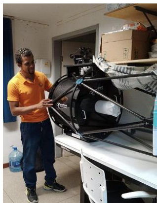
Figura 30 - Telescópio CDK20 com foco Cassegrain do Observatório Antares (Brasil).
