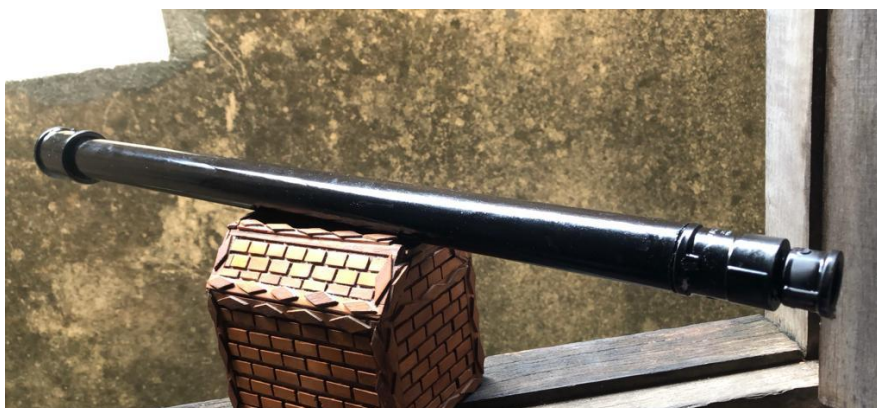
Figura 17 - telescópio refrator kepleriano construído por Filipe Nunes
