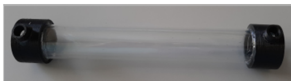
Figura 2. Tubo montado. Na foto são visíveis os dois tubos (interno e externo), e o espaço entre eles para a circulação do líquido de refrigeração
