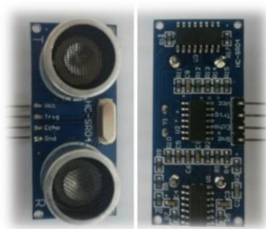
Figura 2.11 - Imagem de um sensor ultrassônico (modelo HC – SR04). Fonte: foto do autor
