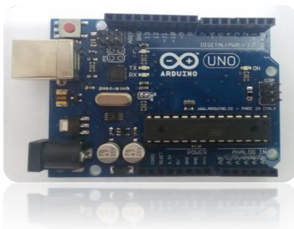
Figura 6 - Imagem da placa Arduino UNO. Fonte: foto do autor
