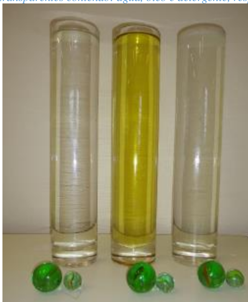
Figura 2: Materiais utilizados para a realização dos quatro experimentos: Bolinhas de gude e recipientes cilíndricos transparentes contendo: água, óleo e detergente, respectivamente
