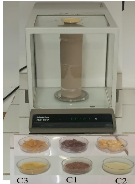
Figura 2. Fotografia da montagem experimental e dos cereais integrais e em pó estudados.
