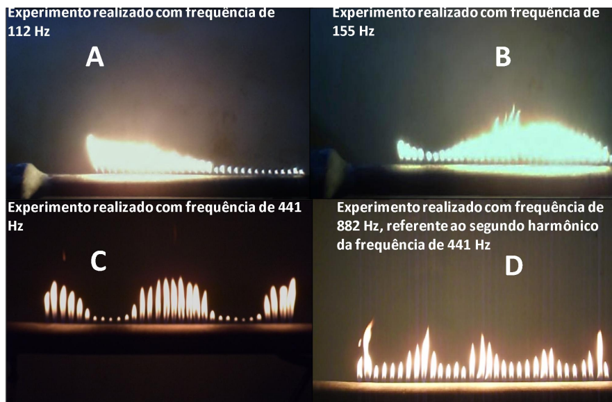
Figura 4 - Resultados obtidos no Tubo de Rubens com frequências de 112 Hz, 155 Hz, 441 Hz e 882 Hz. (Próprio autor).
