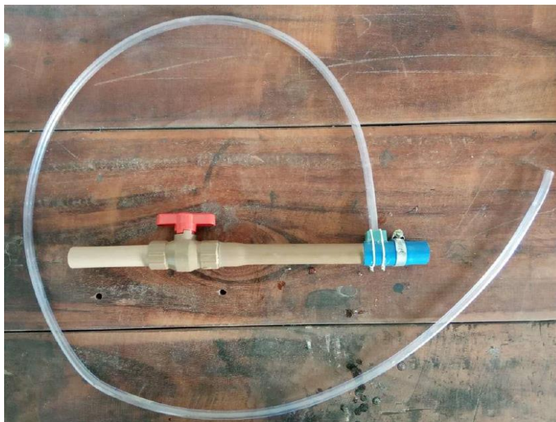
Figura 6: Disposição final da segunda tomada de pressão. Fonte: Autor (2021)
