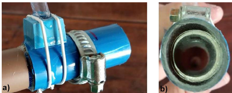
Figura 5: Detalhes: a) Externos e b) Internos da primeira tomada de pressão. Fonte: Autor (2021)
