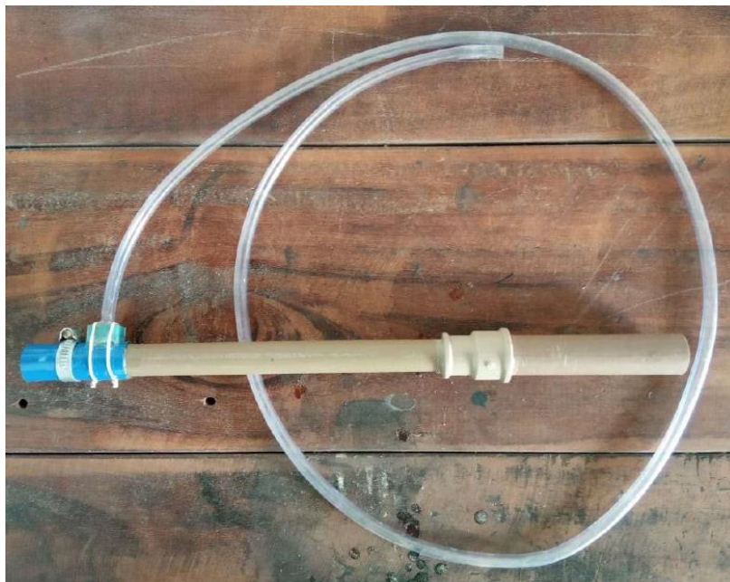
Figura 4: Disposição final da primeira tomada de pressão. Fonte: Autor (2021).
