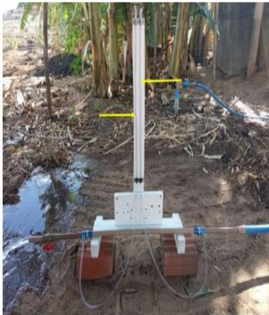
Figura 9: Execução do experimento. As setas indicam a perda de carga (desnível entre os piezômetros). Fonte: Autor (2021)
