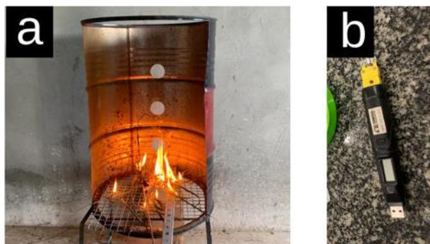
Figura 1. A- Equipamento que foi adaptado a partir de Jaureguiberry et al. (2011), utilizado no experimento de queima do candombá ( Vellozia pyrantha A.A.Conc.), para mensuração das temperaturas. B- Data logger utilizado para registrar as temperaturas.
