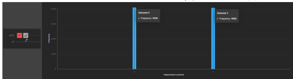
Fig. 2: Porta Hadamard aplicada à um qbit e sua medição (8192 shots) utilizando o simulador simulator_stabilizer encontrado na plataforma da IBM-Q.
