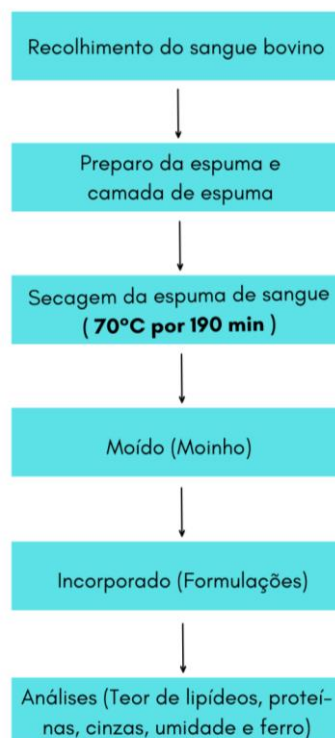
Figura 1: Fluxograma de processo para obtenção de sangue bovino em pó Secagem por camada de espuma
