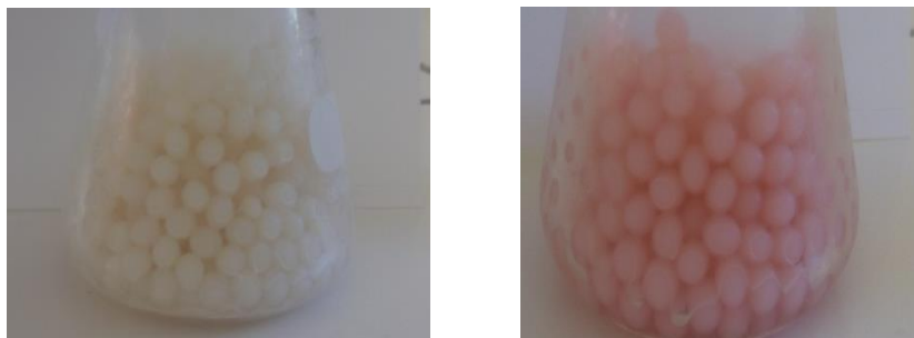
Figura 1: A) Esferas de Alginato com Cloreto de Cálcio. B) Esferas de Alginato com Cloreto de Cálcio e Cloreto de Cobalto (II).
