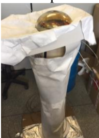
Figura 4- Tubo removível com 4 alturas, e a PMT para detecção. Toda a parede do tubo foi revestida de tyvek .
