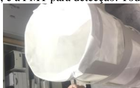
Figura 5- 'Esqueleto' com tyvek colocado dentro do detector.
