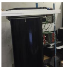
Figura 6- Parte superior do detector com cintilador+PMT.
