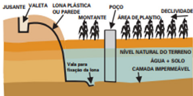
Figura 5: Corte transversal de uma barragem subterrânea, 2011.
