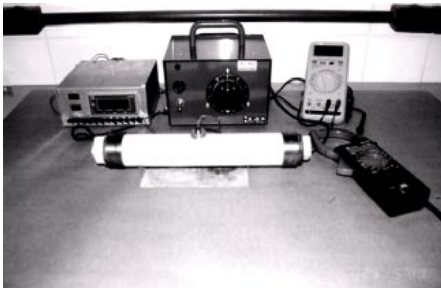
Figura 1 – Esquema para a medida da condutividade elétrica na célula condutivimétrica, durante o aquecimento ôhmico.
