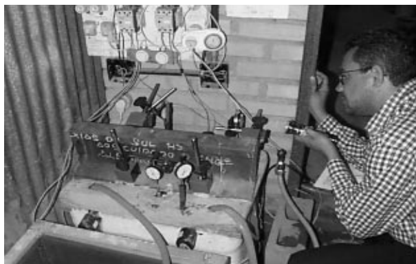
Figura 3 - Ensaio de dilatação em água. Leitura de relógio comparador
