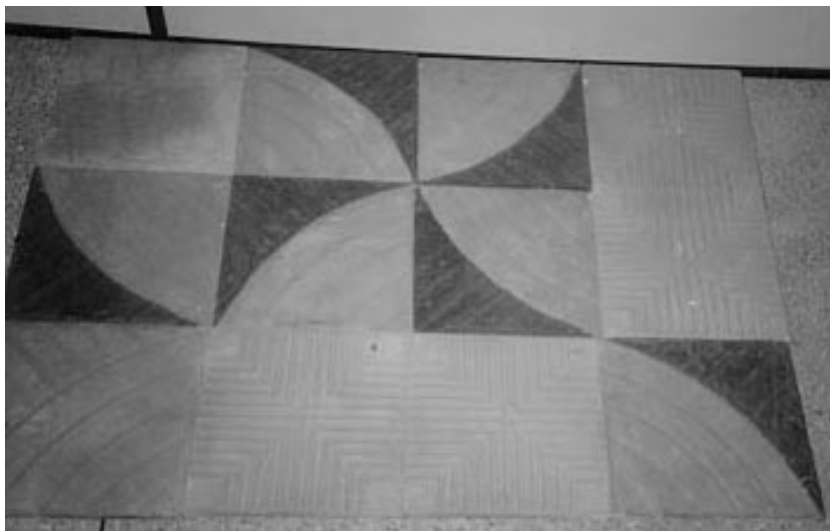
Figura 6 - Aspecto de variados padrões de piso de lajota de argamassa com RCMG
